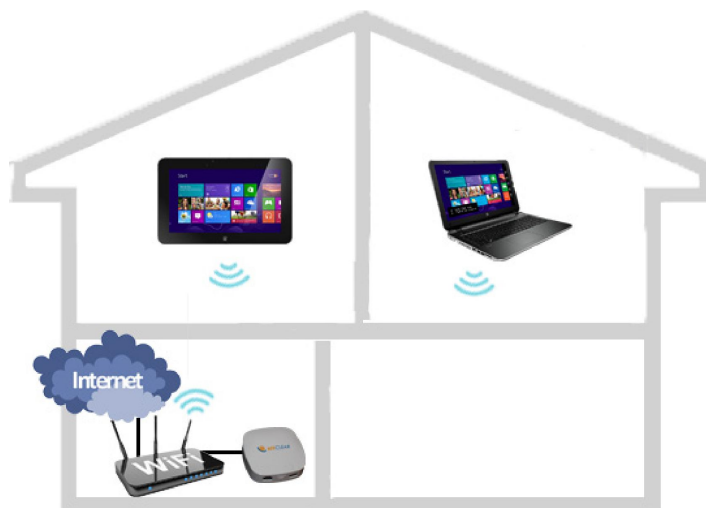
Figuur 9: BeeClear bekabeld aangesloten
